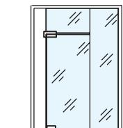
Pivot superior para vidro com fixação Parede/Vidro
